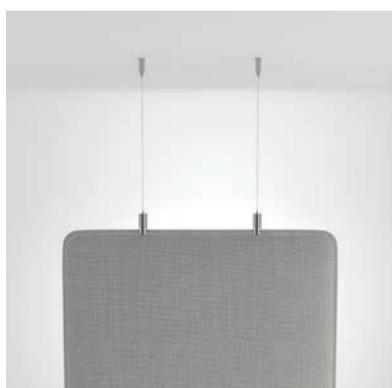
I pannelli Phonolook Design ECO modello TWIN si possono installare in sospensione verticale dal soffitto (a baffle) mediante cavi in acciaio plastificati, cilindri con grano e morsetti filettati, forniti nel kit di fissaggio. Per questo tipo di installazione, che garantisce la fono-assorbenza su entrambe le facce dei pannelli, questi sono dotati di appositi fori su uno dei lati.
