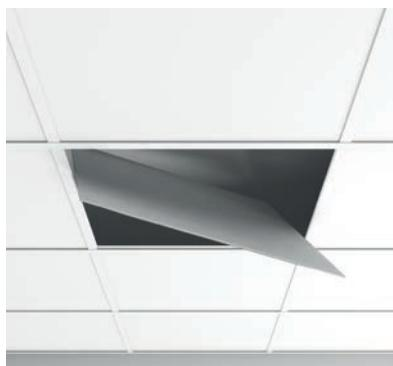
Per procedere all'installazione dei pannelli Design ECO tipo Quadro Plus si devono prima rimuovere alcuni dei pannelli che costituiscono il controsoffitto esistente o progettato. Successivamente si devono posizionare i nuovi pannelli appoggiandoli alla struttura esistente, ajustandoli in posizione perfettamente planare, mediante il bordo perimetrale schiacciato che ne garantisce una posa semplice e sicura.
