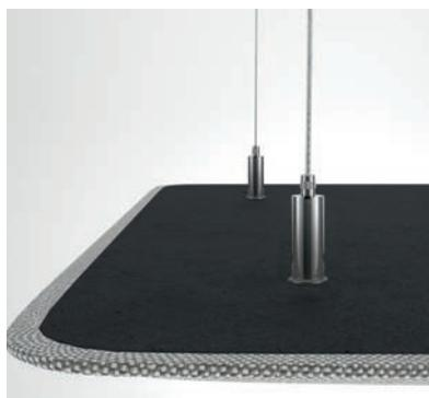
Grazie al sistema a barre di rinforzo posteriori è possibile fissare i cilindri direttamente alle barre stesse, in modo pratico e veloce, e avvitare ai cilindri i morsetti mediante i quali regolare la lunghezza dei fili per la sospensione del pannello all'altezza desiderata.
