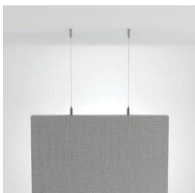
Ciascun pannello della linea Phonolook Solution si può installare in sospensione verticale dal soffitto (a baffle) mediante cavi in acciaio plastificati, cilindri e morsetti filettati, forniti nel kit di fissaggio. Per questo tipo di installazione, che garantisce la fono-assorbenza su entrambe le facce dei pannelli, i cilindri sono direttamente fissati su uno dei lati esterni del telaio perimetrale rivestito in tessuto.
