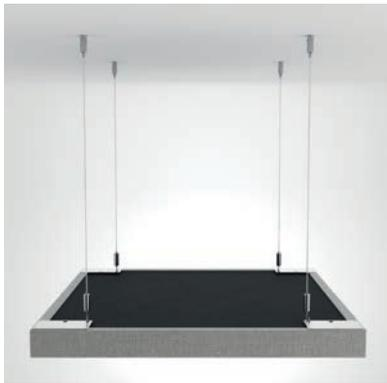
Ciascun pannello della linea Phonolook Solution si può installare in sospensione a soffitto mediante cavi in acciaio plastificati e morsetti con gancio, forniti nel kit di fissaggio. Per questo tipo di installazione, che permette di attivare la fono-assorbenza su ambo i lati dei pannelli, questi sono dotati di apposite piastre con fori fissate sulla cornice perimetrale del pannello in corrispondenza degli angoli.
