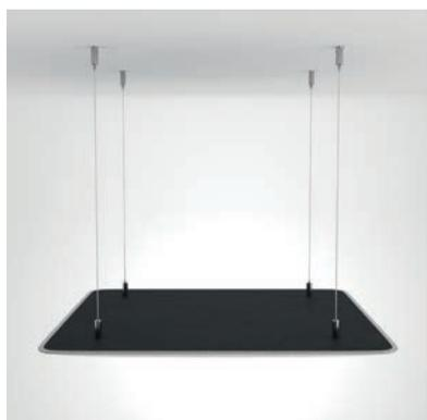
Ciascun pannello della linea Phonolook Design ECO si può installare in sospensione a soffitto mediante cavi in acciaio plastificati, cilindri e morsetti filettati, forniti nel kit di fissaggio. Per questo tipo di installazione, che garantisce la fono-assorbenza su entrambe le facce dei pannelli, questi sono dotati di appositi fori visibili su una delle facce.
